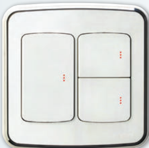
라피네)2개용 3구 램프형 스위치 1Way 1+2Gang W/Lamp 16A 250V~ 928151
