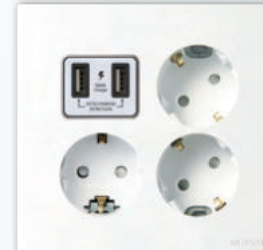
FS)USB 콘센트 3구 (고속충전) (직류전원장치겸용) (DC 5V 2A(Max)/DC 9V 1.67A) 16A 250V~ 925110
