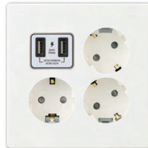
V) USB 콘센트 3구 (고속충전) (직류전원장치겸용) (DC 5V 2A(Max)/DC 9V 1.67A) 16A 250V~ 930146
