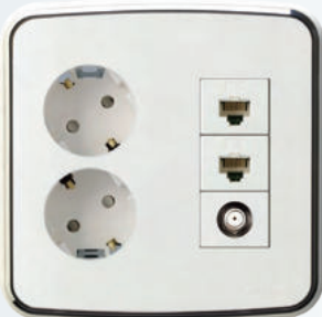
라피네)2개용 통합수구 / 좌콘 동매2구+8P+8P+CATV1방5dB 928484 라피네)2개용 통합수구 / 좌콘 동매2구+8P+8P+CATV2방8dB 928485
