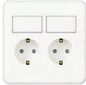
J) 2개용 스위치부 접지 콘센트 2Gang 1Way & Receptacle 2Gang 16A 250V~
