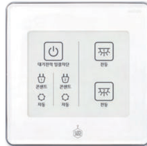
RS) 대기전력 자동차단 스위치 2개용 (대기2+전등2) AC 220V / 60Hz, 회로별 16A+3A 991072
